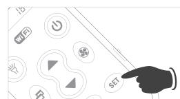
3. Lassen Sie die Taste SET sofort los, sobald das akustische Signal das Einschalten der Klimaanlage bestätigt und probieren Sie die Bedientasten aus. Wenn sie richtig funktionieren, ist die Programmierung beendet, andernfalls wiederholen Sie die Schritte 2-3.
