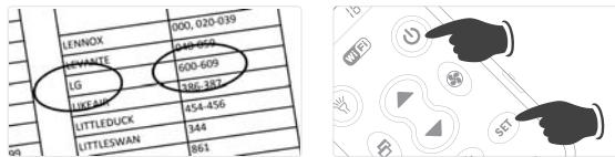
3. Pulsar la tecla SET para salir de la programación y probar las teclas de control del aparato. Si funcionan correctamente, la programación ha terminado. De lo contrario, repetir los puntos 2-3 con el código siguiente.
