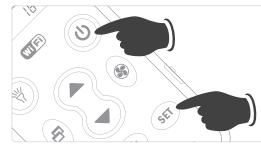
3. Drücken Sie die Taste SET, um die Programmierung zu verlassen und probieren Sie die Bedientasten der Klimaanlage aus. Wenn sie richtig funktionieren, ist die Programmierung beendet, ansonsten wiederholen Sie die Schritte 2-3 mit dem nächsten Code.
