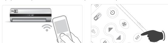
3. Soltar inmediatamente la tecla SET en cuanto la señal sonora confirme el encendido del aparato y probar las teclas de control. Si funcionan correctamente, la programación ha terminado. De lo contrario repetir los puntos 2-3.
